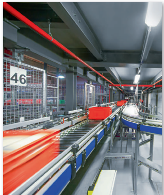
Perfekt vernetzt: Die zum Auftrag gehörenden Teile werden über weite Förderstrecken von den Lagerorten an den richtigen Packplatz geliefert.
