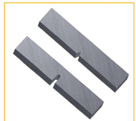
Kerbschlagproben, oben: ISO-V-Probe; unten: ISO-U-Probe
