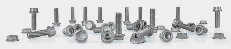
Mit RIPP- und Sperrzahn-Schrauben und -Muttern führt REYHER hochwertige formschlüssige Sicherungselemente im Programm. Viele Abmessungen in den Festigkeitsklassen 90 (~8.8) und 100 (~10.9) sowie mit den Oberflächenbeschichtungen Zinklamellenüberzug oder galvanisch verzinkt sind sofort lieferbar.
