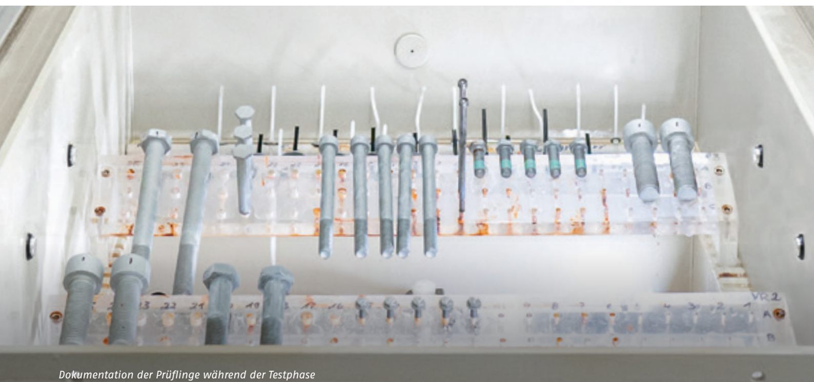
Kammer für Salzsprühnebeltests
